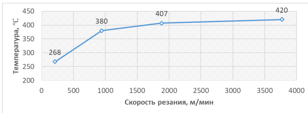
Рис. 4. Зависимость температуры от скорости резания
