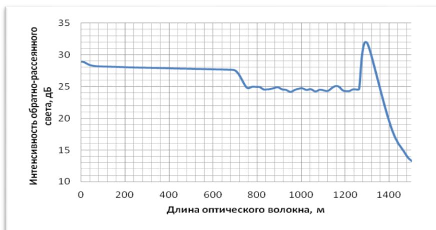
Рисунок 5. Поляризационная рефлектограмма (от 0 до 700м – анизотропное оптическое волокно типа Панда, от 700м – изотропное оптическое волокно SMF-28).
