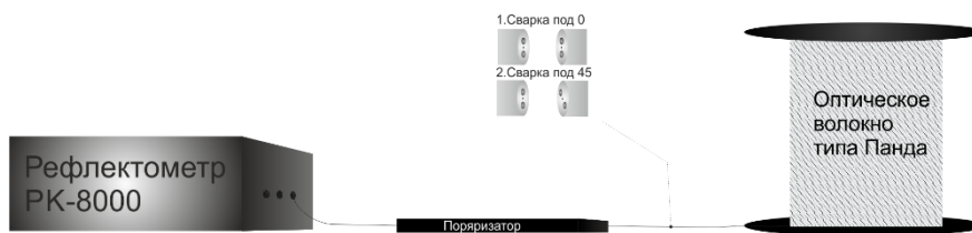
Рисунок 2. Схема методики измерения распределенного h-параметра
